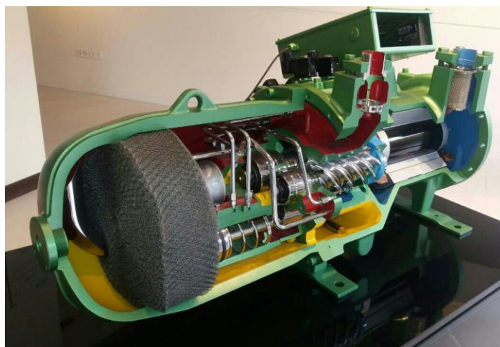
شکل شماره ۱-۴- برش کمپرسور روغنی
