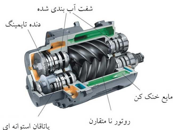
شکل شماره ۱-۳ - برش کمپرسور بدون روغن
